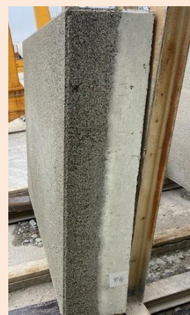
Prototype de panneau de revêtement en béton avec balle de riz
